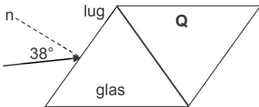
Die ligstraal beweeg vanaf die glasprisma en dring prisma **Q** teen 'n invalshoek van  $36^\circ$  binne. Die brekingshoek in prisma **Q** is  $41^\circ$ .
