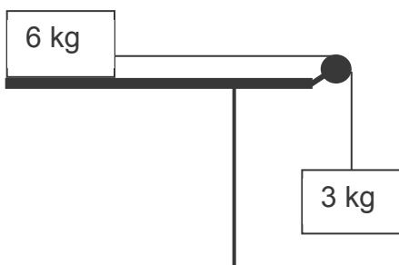
Wanneer die 6 kg-blok vrygelaat word, versnel dit na regs en ondervind 'n kinetiese wrywingskrag van 24 N. Ignoreer die effekte van lugweerstand.
