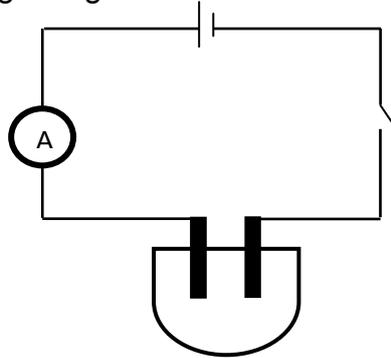
Die anhidriese  $\text{AgNO}_3$  is lepel vir lepel by  $200 \text{ cm}^3$  gedistilleerde water gevoeg. Die ammeterlesing is geneem nadat elke lepel bygevoeg is. Die resultate word in die tabel hieronder getoon.
